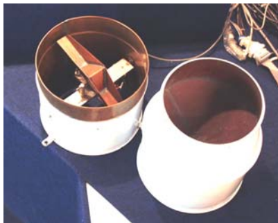
Tipping-bucket Rain-gauge 翻斗式雨量器
